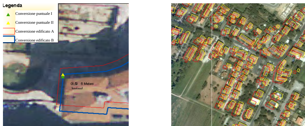
Figura 1 - Conversioni puntuali e poligonali: verifica degli errori rispetto alle ortofoto del portale cartografico nazionale (a sinistra) ed esempio di correzione (contorni chiari) rispetto all'originale (contorni scuri) in prossimità di un cambio di immagine (linea bianca) nella cartografia di Google Earth (a destra).
