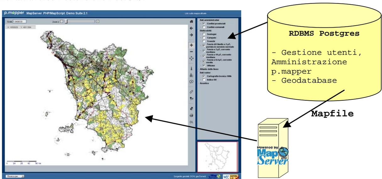
Figura 1 – Architettura del sistema.
